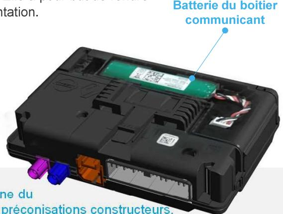
Selon les montages, il peut être nécessaire de remplacer cette batterie :
